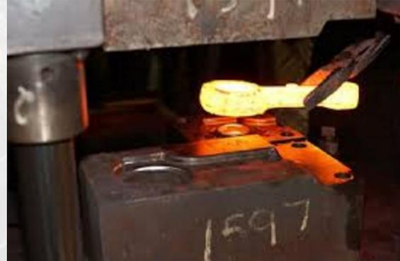
Il prodotto ottenuto mediante stampaggio a caldo presenta dei vantaggi come la tipica disposizione delle fibre lungo il profilo del componente, caratteristica che risulta ideale in particolare nei componenti meccanici destinati a resistenza a fatica. Lo stampaggio a caldo permette inoltre di utilizzare sovrametalli ridotti che limitano così il peso del materiale utilizzato nonché le lavorazioni meccaniche che devono asportare ridotte quantità di materiale.
